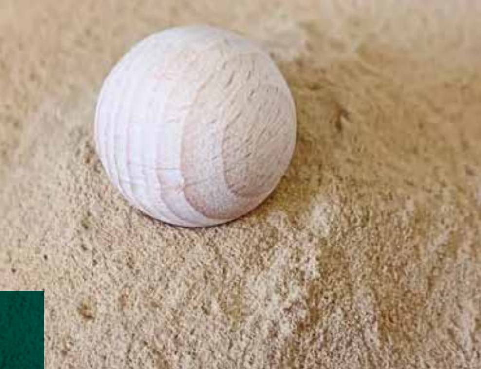
Kleine Kugel, große Wirkung: Tausende Spielzeugholz­kugeln rotieren im Aeroben Thermo-Trockner. Sie sorgen dafür, dass die Suspensionen sehr schnell und hoch trocknen. Zudem verrotten diese nicht und die Holzkugelschüttung ist luftdurchlässig.
